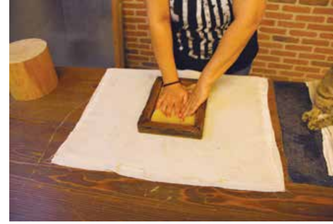
7- Kasnağın içine sünger ile bastırılarak suyu alınır ve kasnaktaki ince hamur tabakasının bez üzerine geçmesi sağlanır.
